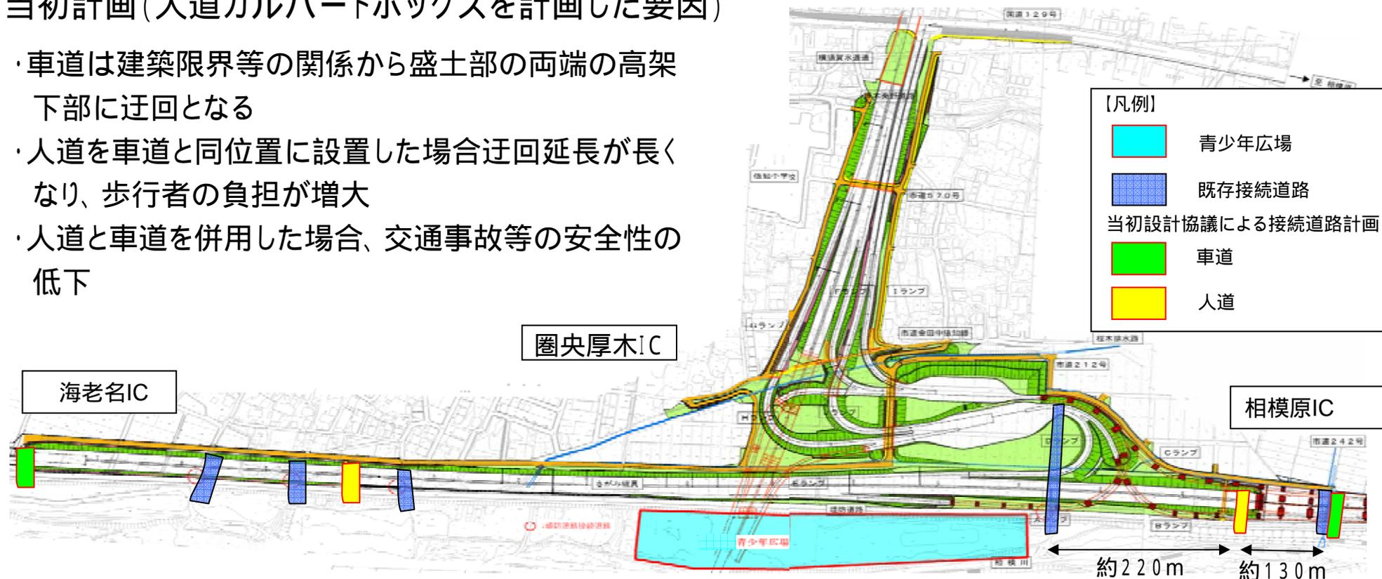
盛土構造に伴い地元居住地域から相模川の堤防への新たな接続道路は、既存の5箇所から車道2箇所、人道カルバートボックス2箇所に集約する計画として合意
