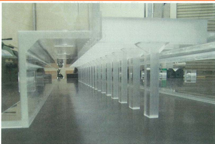
模型実験用掘割構造(1/100縮尺)
