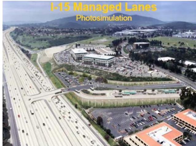
I-15 に隣接するバスセンター（Bus Rapid Transit Center）と高速レーン(中央)に直接出入りするランプ（DRA=Direct Access Ramp）の構想図。高速レーンは、公共交通機関、相乗りのワゴン・普通乗用車、オートバイ、承認を受けた低公害車が無料で通過でき、FasTrak と呼ばれる ETC システム車載器搭載車両であれば、一人乗車の車両も料金を支払って通行ができるとされている。
