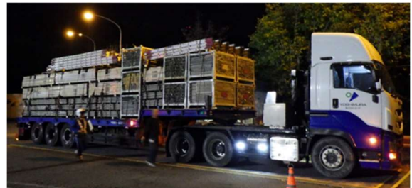
・当該車両の車両総重量の実測値: 51.15t (車両制限令の一般的制限値 25.00t の 2.04 倍)
