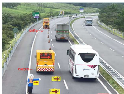
《工事規制矢印板・ラバーコーン自動設置・撤去車両（ロボコーン・ロボアロー）》
