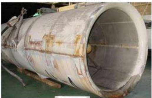
《トンネルジェットファン（補修前）》
