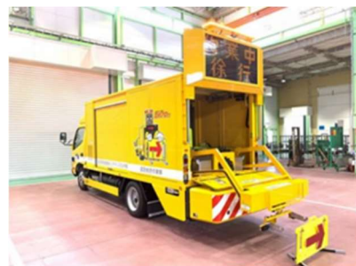
《工事規制矢印板・ラバーコーン自動設置・撤去車両（ロボコーン・ロボアロー）》
