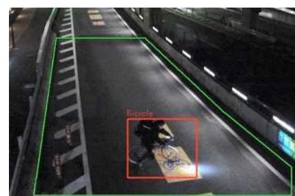
検知・警告システム検知例 (目黒入口)
