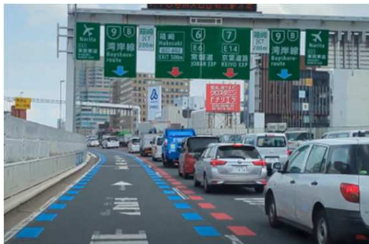
路面標示設置・看板改良による交通整流化 （6号向島線下り江戸橋 JCT～箱崎 JCT）
