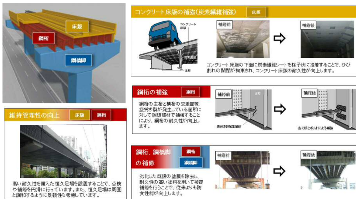
大規模修繕の主な実施工種
