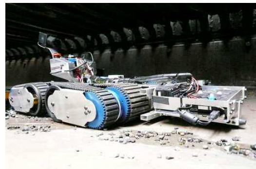
狭隘部用点検用ロボットによる点検
