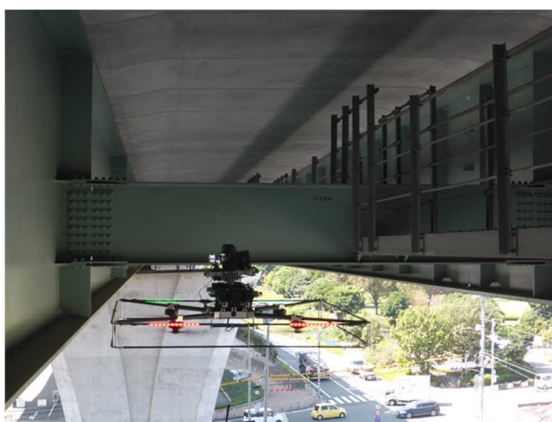
【無人航空機(UAV)を用いた橋梁の点検実施状況】
