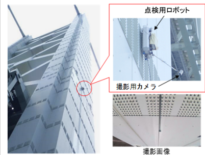
(高所点検用ロボットの検討)
