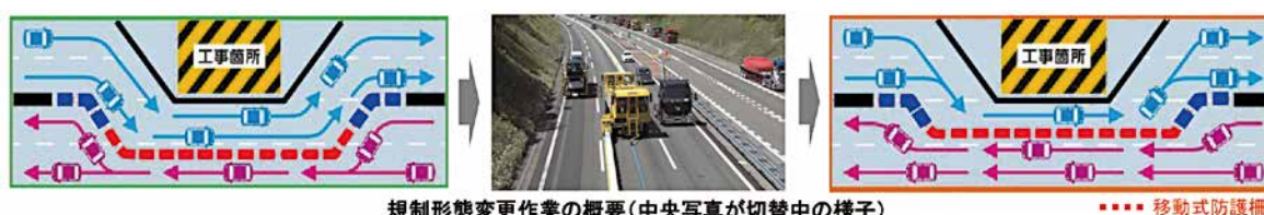
規制形態変更作業の概要(中央写真が切替中の様子)
