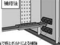
鋼桁の主桁と横桁の交差部等、疲労き裂が発生している箇所に対して鋼板部材で補強することにより、鋼桁の耐久性が向上します。
