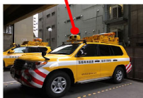
(高性能ドライブレコーダーを活用した路面損傷の自動検出)
