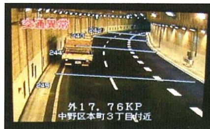
異常事象検出システム
