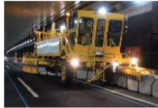
【防護柵切替用車両】
