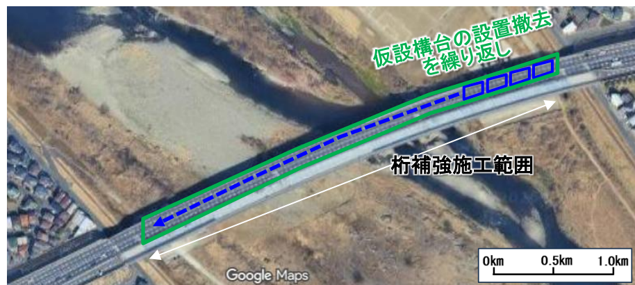
仮設構台設置による桁補強イメージ図
