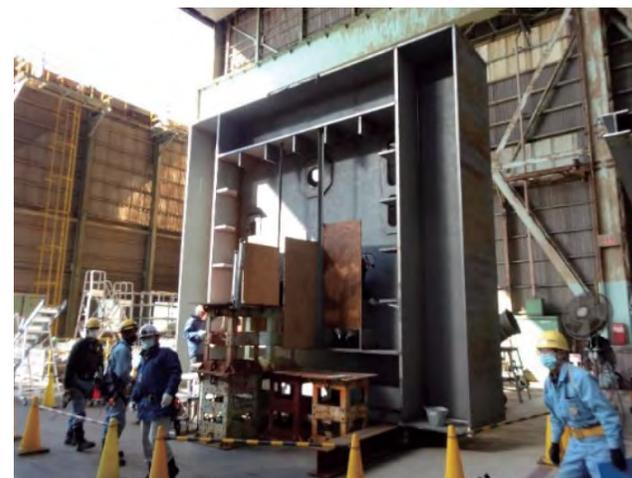
実物大模型による施工試験
