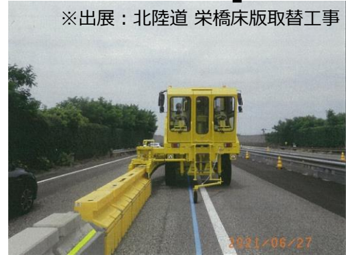
[対面通行規制および車線切替作業の状況]
