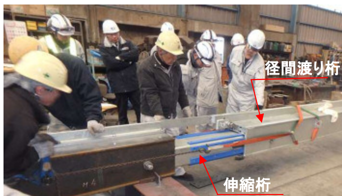
伸縮性能の確認状況
