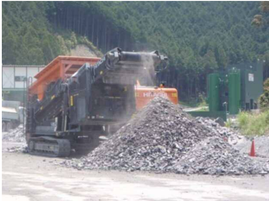
自走式スクリーンによるふるい分け作業
