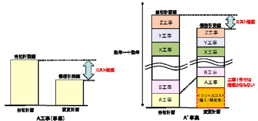
対象事例(移動式防護柵の採用による規制費の縮減)
