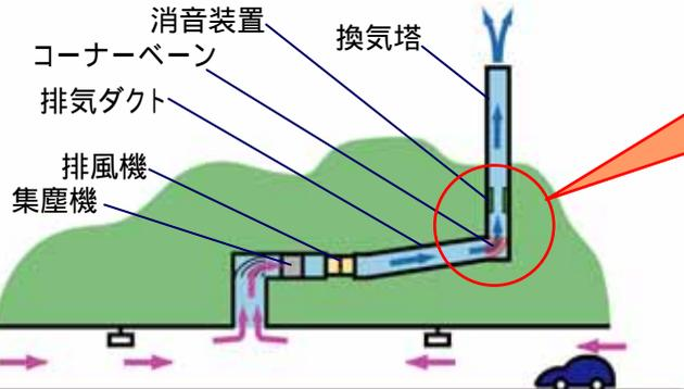
トンネル内で発生した煤煙等を排風機の力で排気口に集め、集塵機でフィルターを通してから、排気ダクトを通して換気塔から屋外に排気する方法
