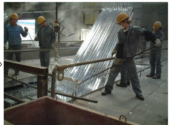
③亜鉛めっき 亜鉛めっき工場へ運搬し めっき処理
