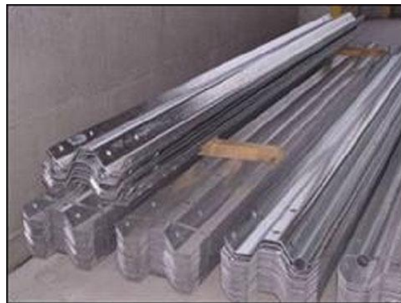
④亜鉛めっき後のガードレール
