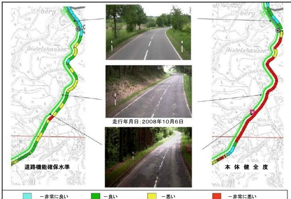
図-15 通行機能水準と本体健全度のビジュアル化による比較対照例
